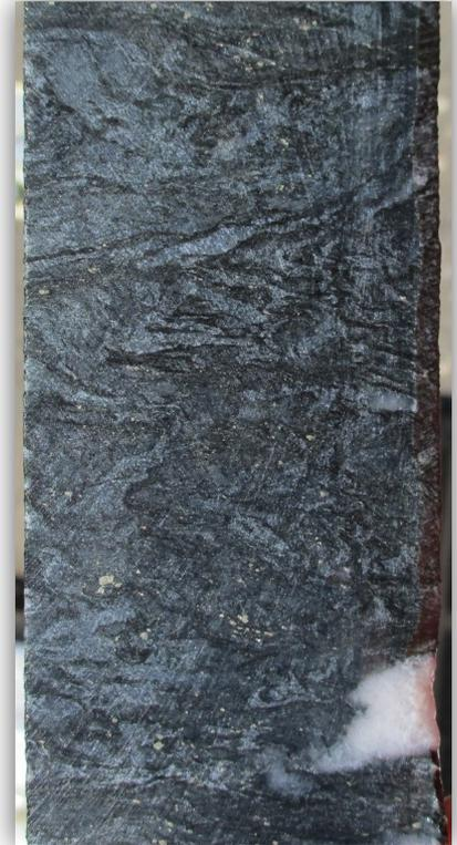
剪切的泥灰岩基质岩有强烈的碳酸盐蚀变。
