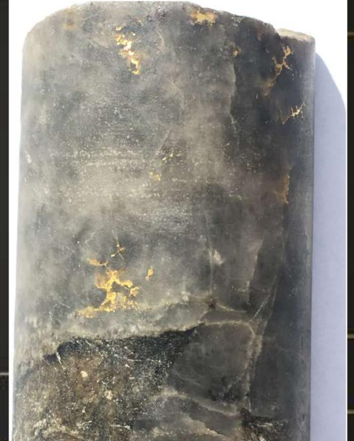
右图：在New Alger钻获的可见金标本样本，除了在石英矿化中显示出惊人的黄金外，在左下角还可见一块含金的黑云母蚀变，这是New Alger品位较低的“光晕”的一部分。这片岩芯的另一部分经检测**金品位高达149.98克/吨**。
