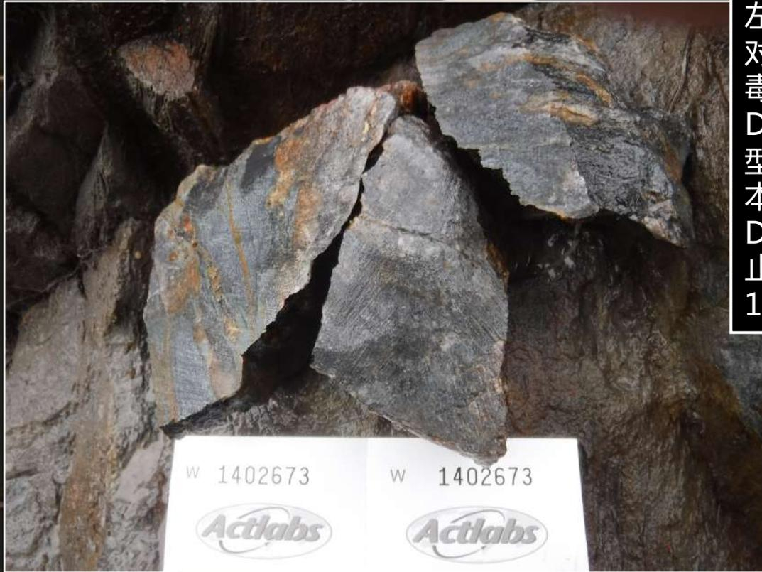
左图：与Cadillac断层带类似，对赋存在石英矿脉群中、经过毒砂蚀变与微黑云母蚀变的Discovery Vein矿化结构的典型槽探取样。在这个特别的样本中，金品位为1.76克/吨，Discovery Vein槽探中迄今为止金品位高低不等，最高可达12.33克/吨。
