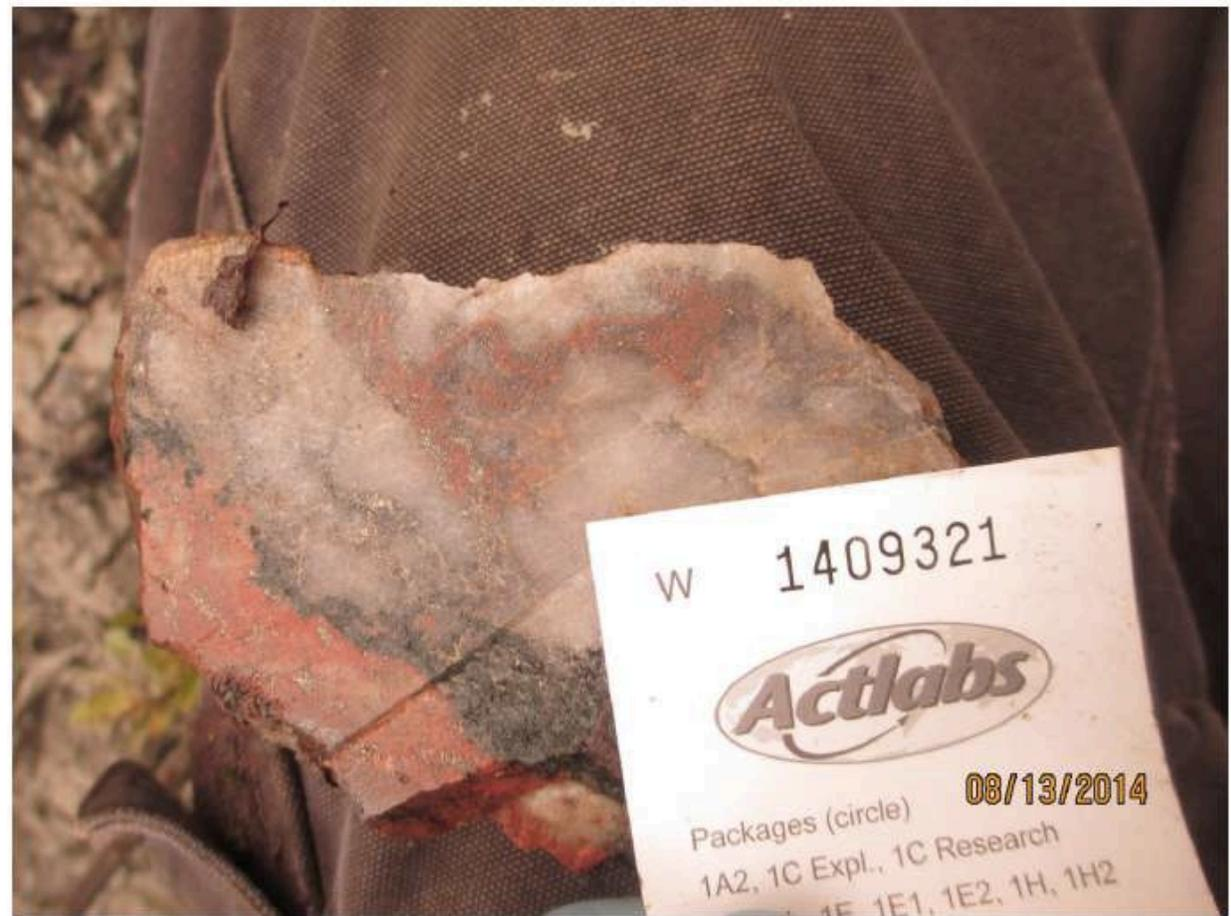
块金效应使样本变得壮观！Nixon Bartleman在上个世纪20年代就被发现，后来断断续续经历了几任所有者。在该项目区生产的黄金品位最高曾达到50克/吨(Teddy Bear Valley Mines)，Renforth在图中所示的0.3米的石英串肠构造体中曾获得22.1克/吨的黄金。
