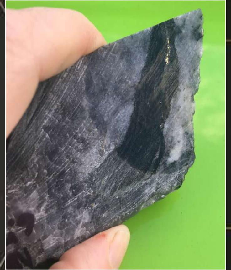
右图：这份岩芯样本取自NA-07-06，一段金品位为6.37克/吨的0.9米矿段。有趣之处在于样本取自深度约35米的地方，而且位于Discovery Vein剥离区域以南。值得指出的是，剥离的Discovery Veins是Pontiac沉积物迄今为止确定的三个水平层的中央黄金层，这份样本来自南面的水平层。
