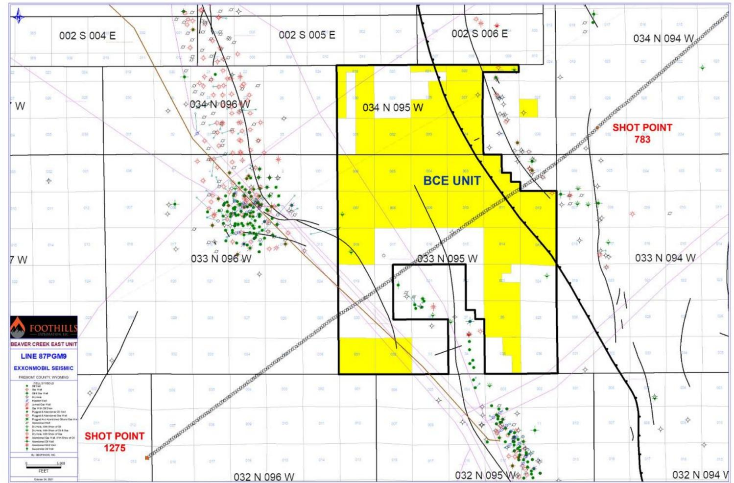
該線的許可部分是從東北方向的783號激發點到西南方向的1275號激發點。獲得的總里程數約為15.0625英里。
