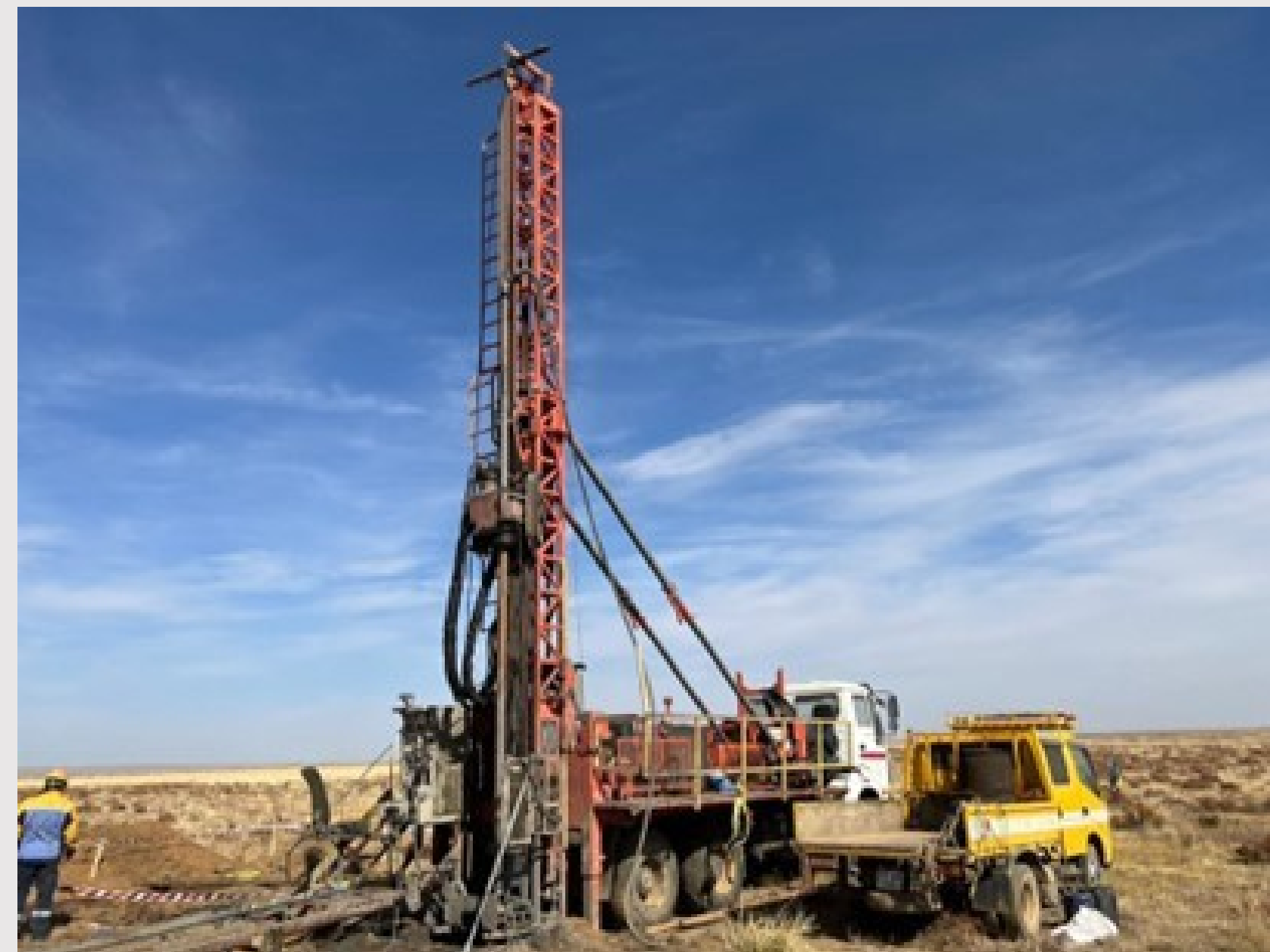
在UNDH-02的金刚石岩芯钻探
